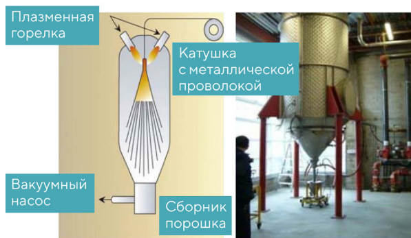
Рисунок 32 —Плазменная атомизация
