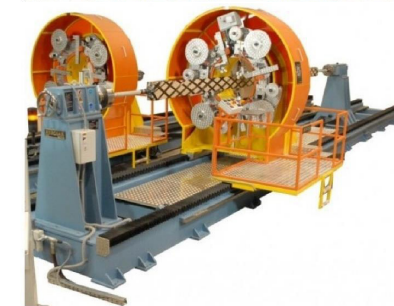
Рисунок 10 – Намотка композитных лопастей вертолета на станке с ЧПУ
