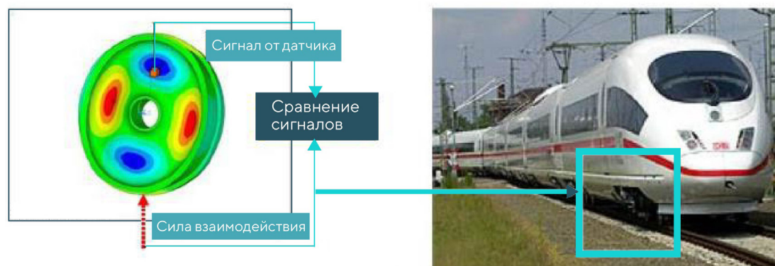
Рисунок 55 – Дефектоскопия вагонных колес
