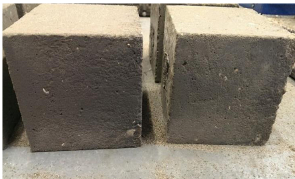
Рисунок 61 – Бетонные блоки с добавкой графена
