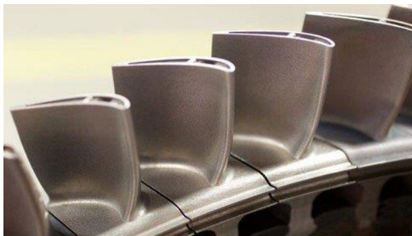
Рисунок 57 – Турбинные лопатки, произведённые из металлического порошка
